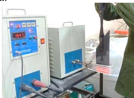
2-rasm. Yuqori chastotali induksion tok bilan termik ishlov berish jihozi.
