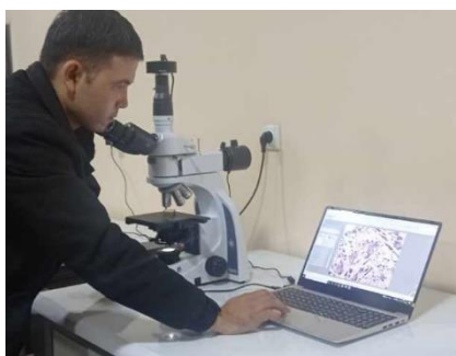
5-rasm. A13.0201-B2 markadagi invertorli-metallografik mikroskop
